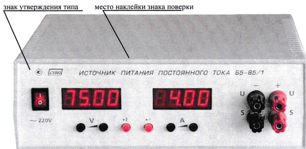
Рисунок 1 – Общий вид источника с указанием мест нанесения знака утверждения типа и наклейки знака поверки
